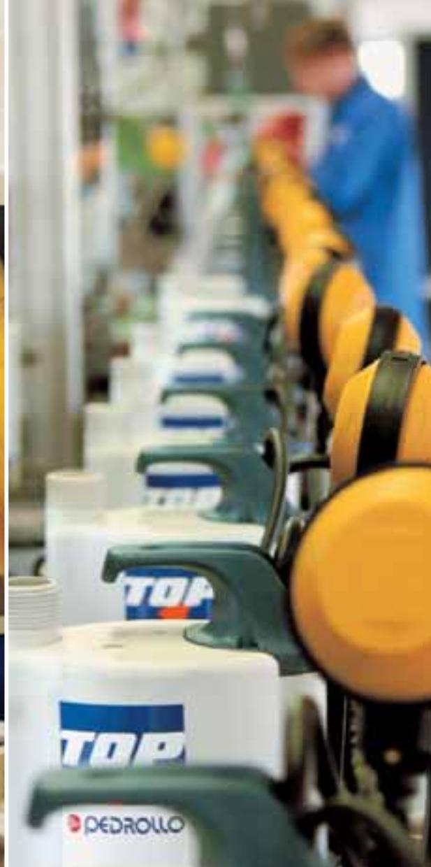
Окончательная сборка наших электронасосов производится на автоматических линиях, гарантирующих высокое качество и выполняющих непосредственный автоматизированный контроль. Это дает возможность получить готовое изделие в кратчайшие сроки.
